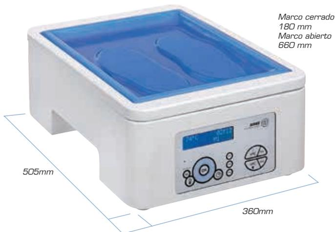
El Mobilab® 2 es un Vacuum que combina calor y vacío para un acabado siempre profesional, todas las técnicas de termo formado son posibles y permite acoplar múltiples accesorios. Dispone de un panel de control táctil multifunción de fácil manejo que permite ajustar la temperatura de calentamiento así como el tiempo de exposición y el vacío en platina superior o salidas exteriores. Dispone de 3 memorias programables.
