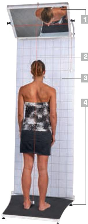
La base del posturómetro posibilita utilizar el aparato en distintas configuraciones: con un podoscopio o con una plataforma de presión tipo Presscam.
