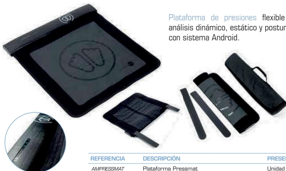
Plataforma de presiones flexible enrollable con software de análisis dinámico, estático y postural de fácil manejo sobre Tablet con sistema Android.
