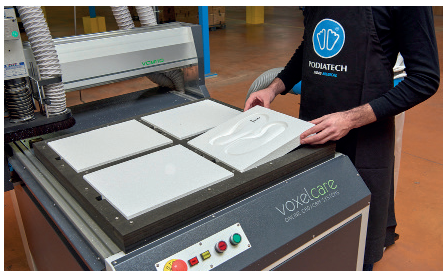
Fresado del molde positivo.
