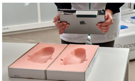
Escaneo de huellas en espumas fenólicas.
