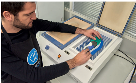
Termomoldeado de la OPCT® sobre el molde.
