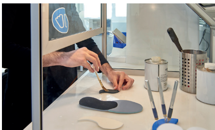
Encolado de los elementos de contención.
