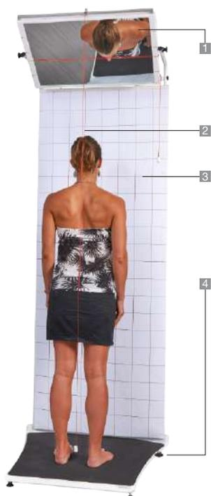
La base del posturómetro posibilita utilizar el aparato en distintas configuraciones: con un podoscopio o con una plataforma de presión tipo Presscam.
