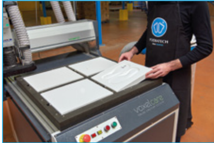
Fresado del molde positivo.
