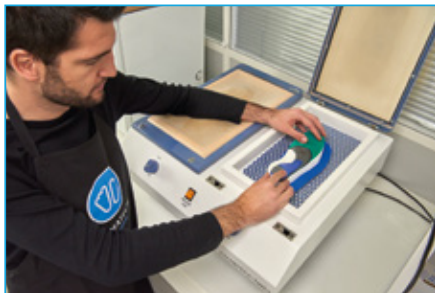
Termomoldeado de la OPCT® sobre el molde.
